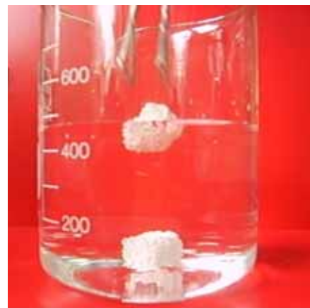
Если поры губки сделать сверхгидрофобными, она перестнет тонуть в воде
